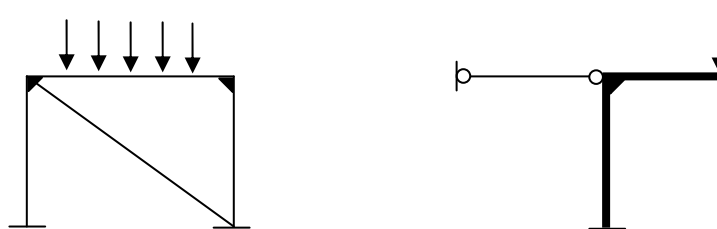
Figura 4.7 – Peças com momentos de extremidade e nós indeslocáveis
