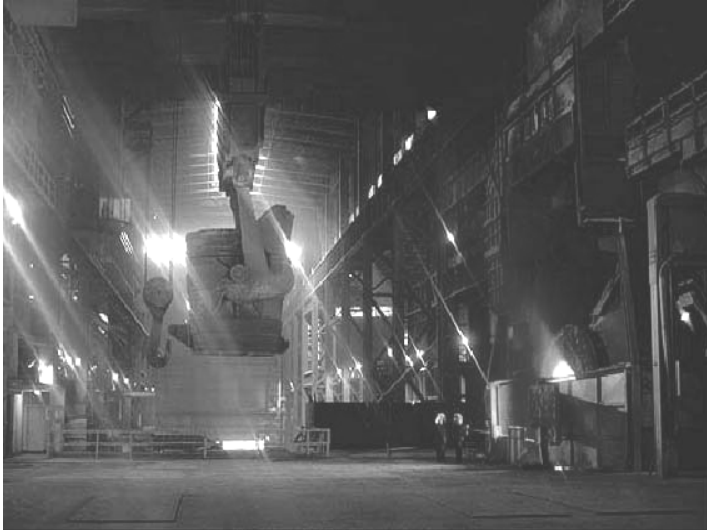
Figura 1.5 – Painel de gusa sendo conduzida, no interior da aciaria, para o conversor onde será transformada em aço
